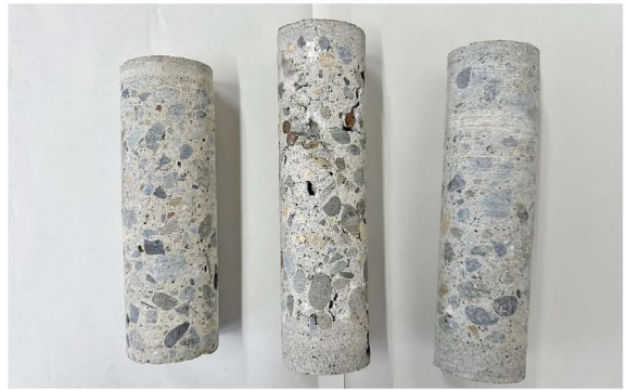
躯体をコア抜きしたもの
